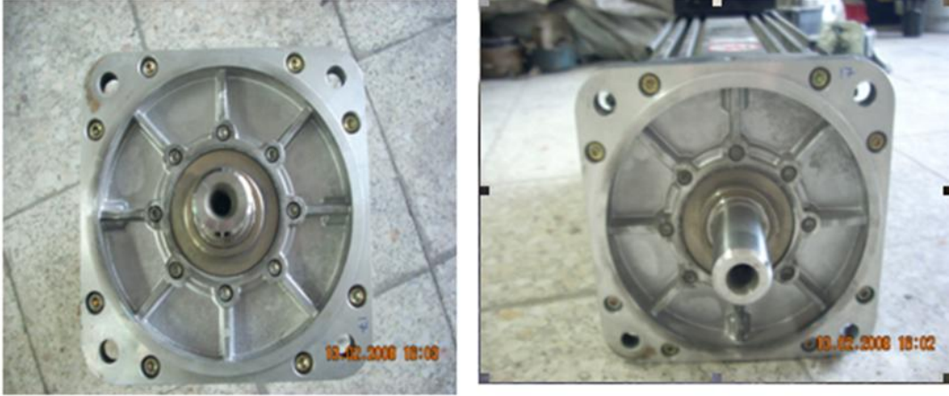
Resim 1.1: Fırçasız servo motorun mil kısmının görünüşü
