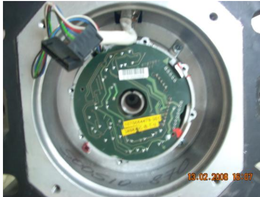
Resim 1.2: Fırçasız servo motorun geri besleme kısmı
