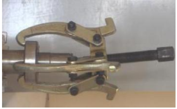
Resim 1.5: Çektirme ile rulman sökümü
