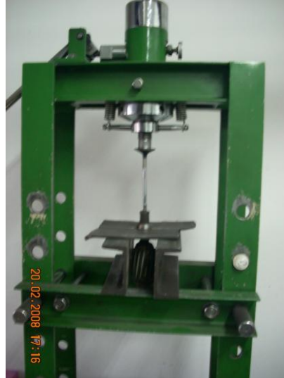
Resim 1. 6: Hidrolik basınç uygulama makinesi
