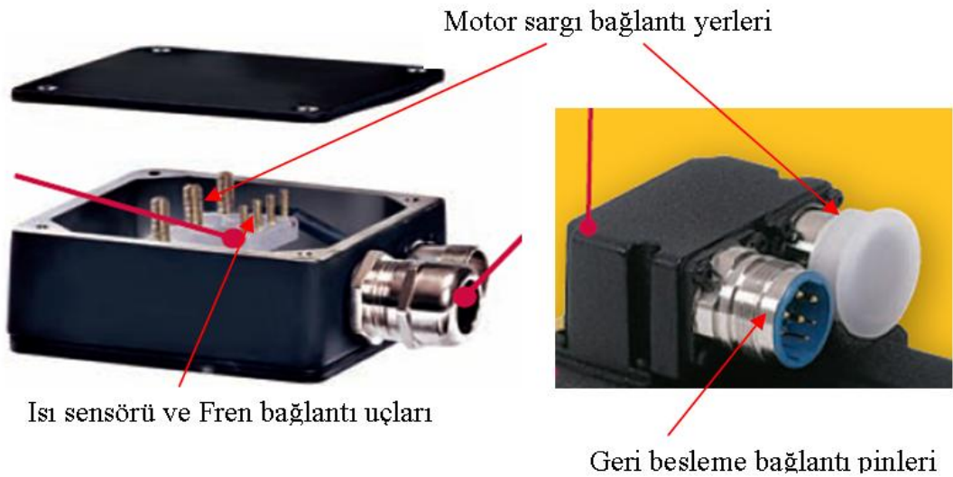
Resim 2. 1: Servo motor bağlantı kutusu
