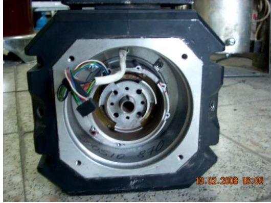
Resim.1.3: Motorun geri besleme kartının sökülmüş hali
