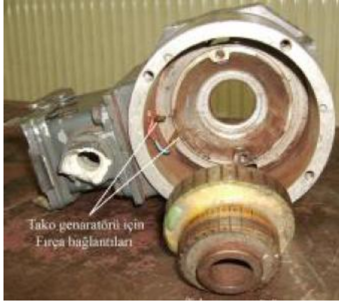
Resim 2. 3: DC takojenaratörü ve fırça bağlantıları
