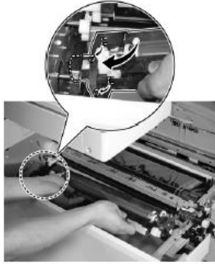
Őekil 2.22: Drum nitesinin ıkarılması (1)
