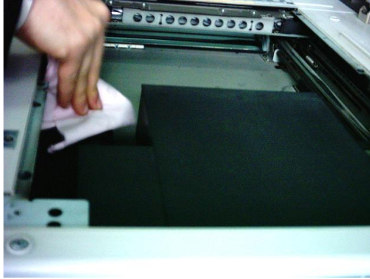
Şekil 2.19: İç kısmın temizlenmesi
