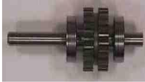
Resim 5.3: Bir adım motor rotoru
