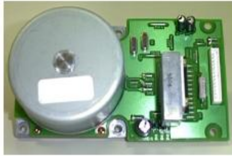
Resim 5.1: Fırçasız doğru akım motoru
