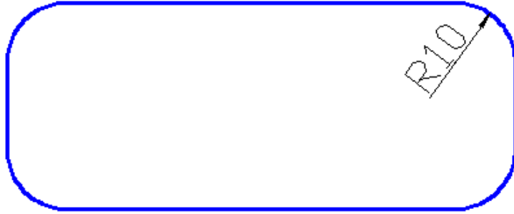
Şekil 2.7: Fillet 10 birim yuvarlama seçeneği ile çizilmiş dikdörtgen
