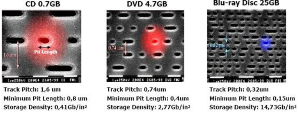
Şekil 2.2: CD, DVD ve BD'lerin iz büyüklükleri ve lazerin okumak için taradığı alanlar
