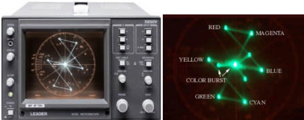
Resim 2.4: Rek çubuğu (colorbar) sinyalinin osilaskop üzerinde görünen şekli ve anlamı
