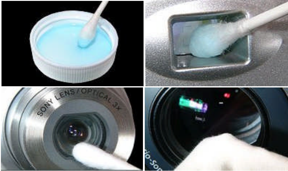
Resim 2.14: Lens temizleme sıvısı ile lens temizliği
