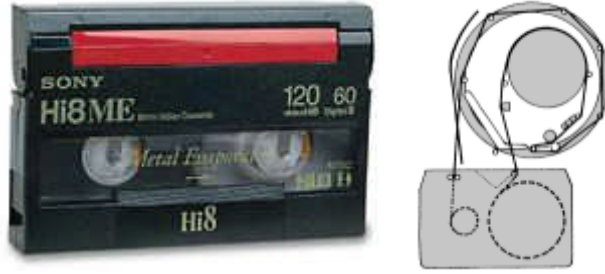
Resim 1.14: Kameralarda kullanılan Video HI-8 kaset ve kayıt şekli
