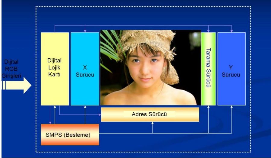
Resim 1.10: PDP blok diyagramı
