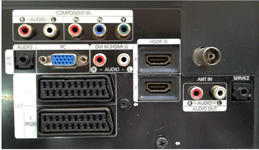
Resim 1.23: Plazma TV arka panel bağlantı noktaları
