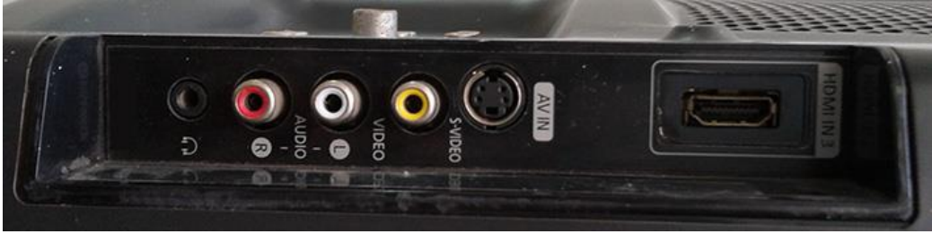
Resim 1.28: Plazma TV yan panel bağlantıları
