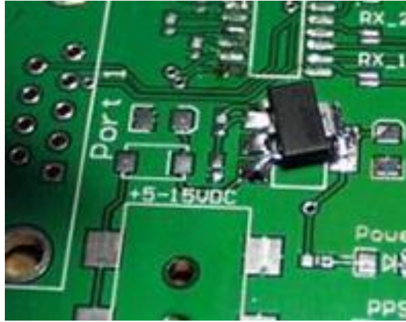
Resim 2.21: SMD transistör sökme işlemi
