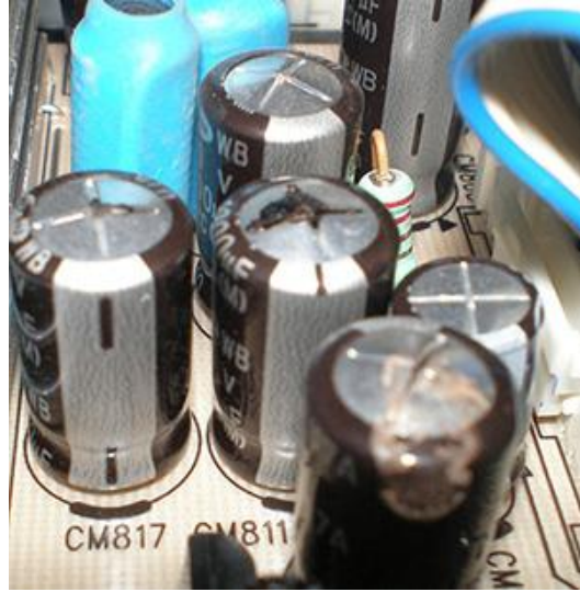
Resim 1.17: Besleme çıkışındaki arızalı kondansatörler
