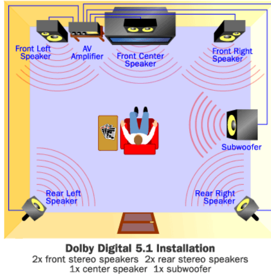
Şekil 1.23: Dolby dijital 5.1 sistemin hoparlör yerleşimi
