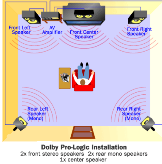
Şekil 1.22: Dolby pro lojic sistemin hoparlör yerleşimi
