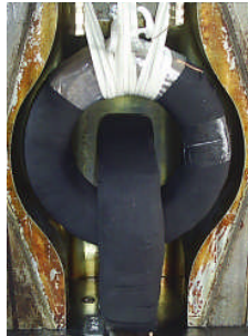
Resim 1. 3: Reçine kalıbına yerleştirilmiş bir gerilim transformatörü
