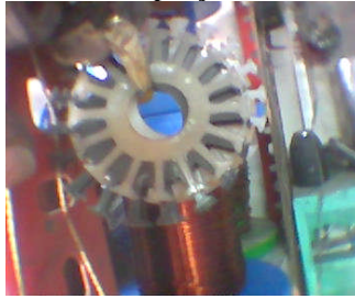
Resim 2.1: Endüvi kenarlarına konulan fiber parça
