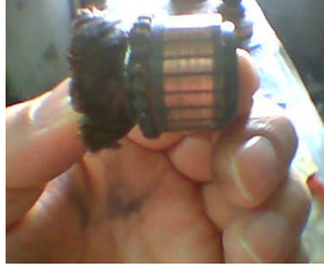
Resim 2.6: Endüviden kesilen bir kolektör
