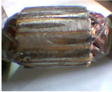
Resim 3.9: Üzeri polyester ile verniklenmiş bir endüvi
