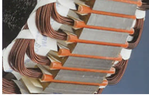
Resim 3.4: Oyukları presbantla kapatılmış bir endüvi
