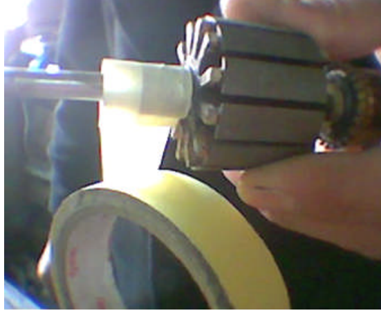
Resim 2.8: Endüvi milinin yalıtılması
