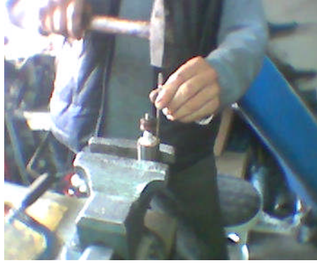
Resim 1.6: Oyuk kamalarının çıkartılması
