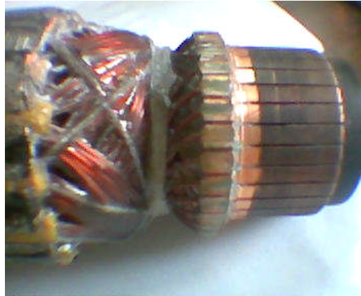
Resim 1.4: Endüvi ile kolektör arasındaki pamuk iplik
