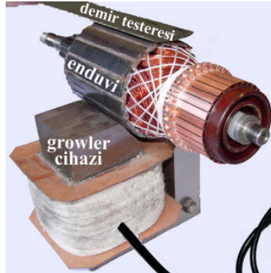
Resim 1.5: Growler cihazı ile endüvide kısa devre kontrolü
