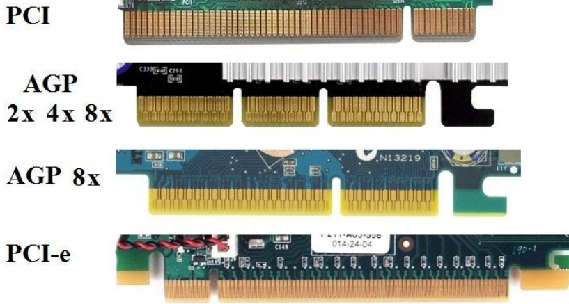
Resim 1.8: Slotlara takılan kart noktaları
