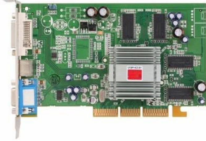
Resim 1.13: AGP Genişleme yuvasına takılan Ekran Kartı
