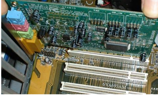
Resim 2.5: PCI genişleme yuvasına takılan ses kartı
