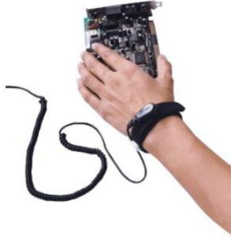
Resim 2.1: ESD bilekliklerin, elektrostatik deşarjı önlemesi
