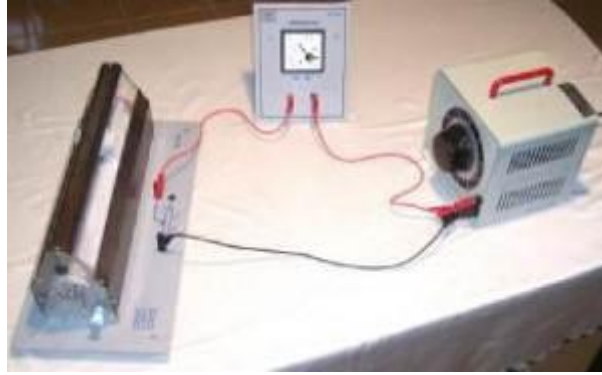
Resim 2.12: Ampermetre ile alıcı akımını ölçmek
