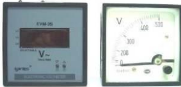
Resim 2.9: a-Dijital pano tipi voltmetre b-Analog voltmetre
