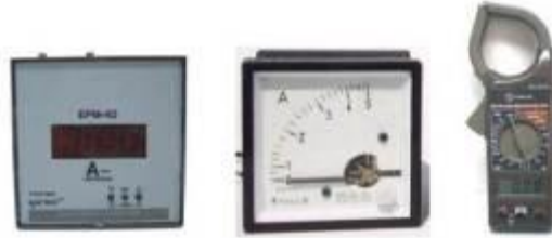
Resim 2.11: a-Dijital pano tipi ampermetre b-Analog ampermetre c- Pens ampermetre
