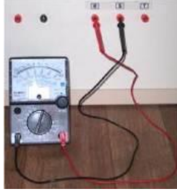
Resim 3.2: Analog avometre ile gerilim ölçme
