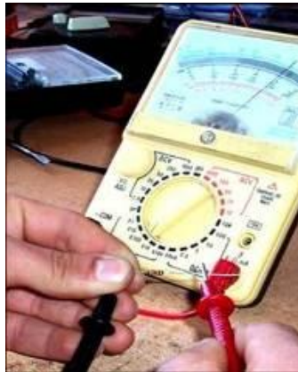
Resim 2.7: Avometre ile direnç ölçümü
