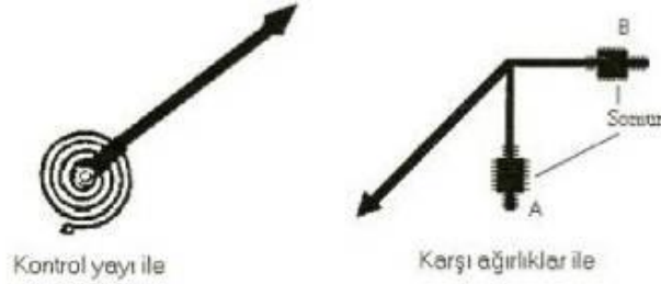
Şekil 1.3 Kontrol yayı ve karşı ağırlıkla kontrol kuvveti
