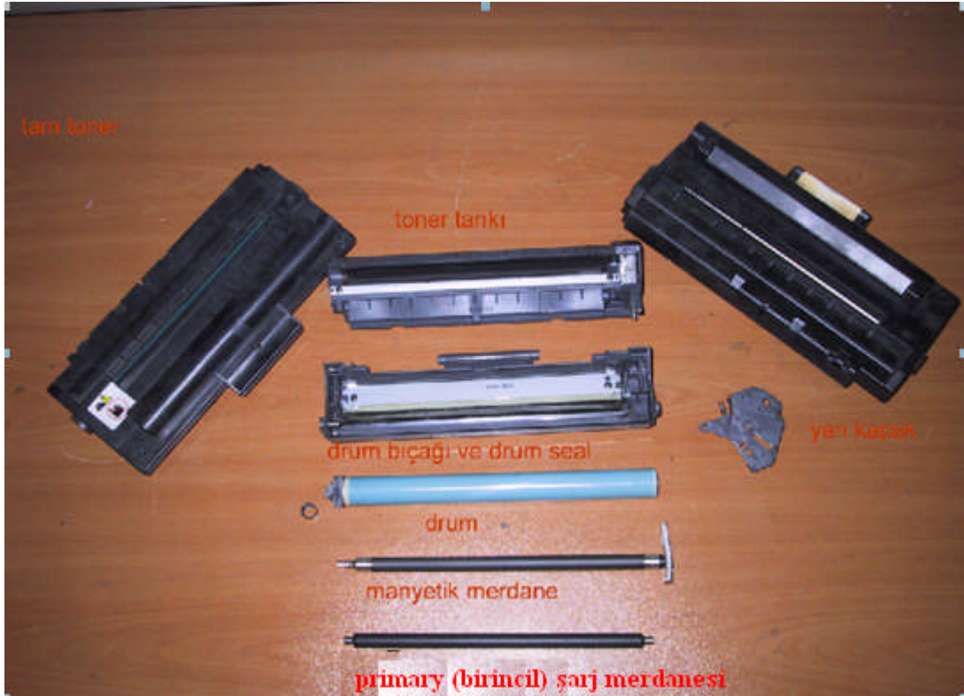
Şekil 1.22: Tonerin iç parçaları
