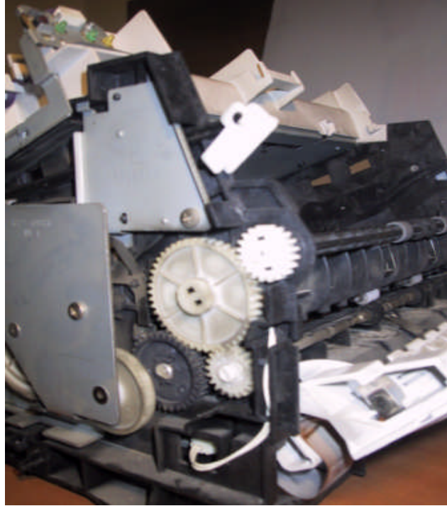
Şekil 1.20: Başka bir model yazıcıda kâğıt çıkarma dişlileri
