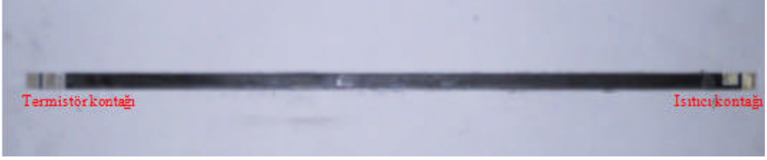
Şekil 1.13: Rezistans çubuğun üstten görünüşü, siyah kısım ısıtıcı yüzey
