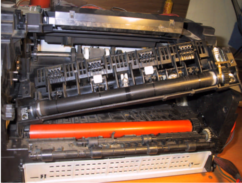
Şekil 1.12: Lambalı fırınlama ünitesinin lazerin ön kısmındaki yerinden ayrılmış hali (alüminyum silindir, döndürücü dişlisi lamba kontakları)
