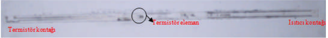
Şekil 1.14: Rezistans çubuğun alttan görünüşü
