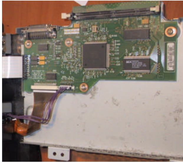
Şekil 1.3: Bir lazer yazıcının en altına monte edilmiş bir I/O board
