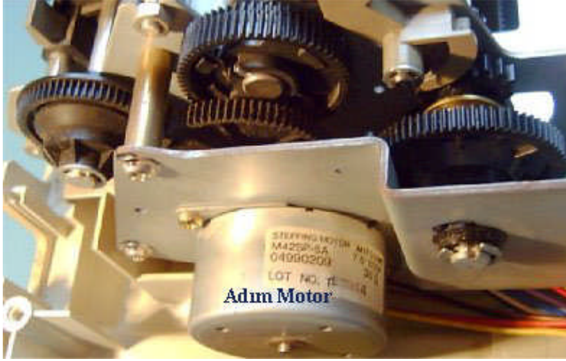
Resim 1.11: Tek kutuplu adım motor ve dişli düzeneği
