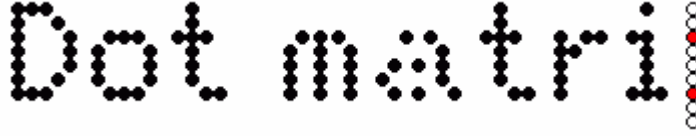
Şekil 1.5: 9 iğneli yazıcının yazma şekli
