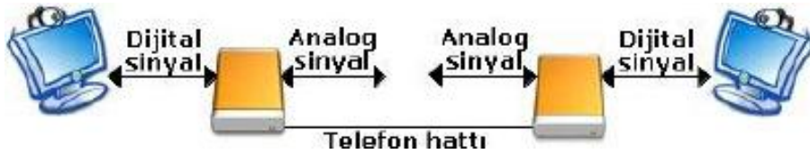
Şekil 2.6. Modem çalışma prensibi
