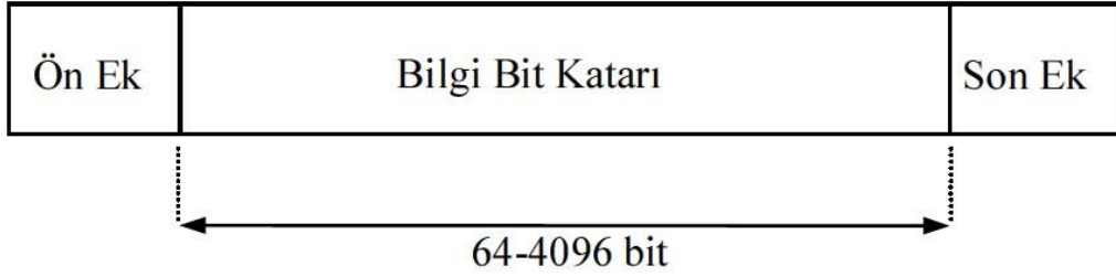
Şekil 1.5. Senkron seri iletişim
