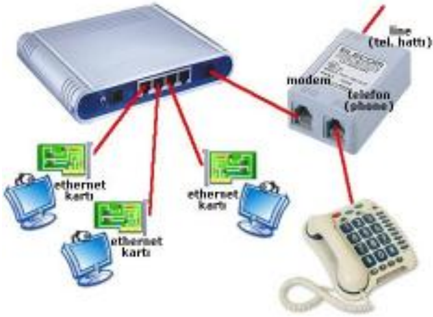
Şekil 2.10: ADSL modem bağlantı şekli
