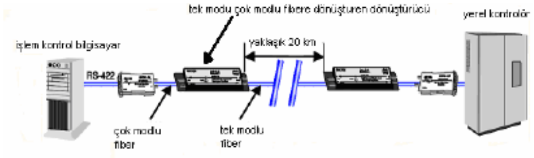
Şekil 3.32: Tek modlu fiberdeki sinyali çok modlu fibere aktaracak şekilde kullanılan dönüştürücüler ve alan içerisinde optik hublar kullanılarak verilerin dağıtılması
