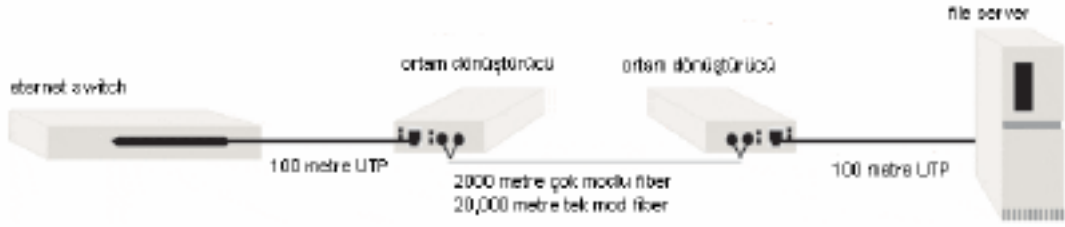
Şekil 3.31: Genel fiber kablo kullanım amacı ve ışığı elektriksel sinyale, elektriksel sinyali ışık sinyale dönüştüren dönüştürücüler
