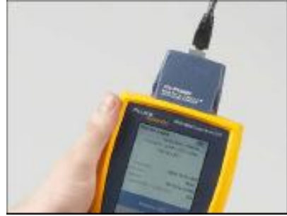
Şekil 2.62: Kablonun test edilmesi
