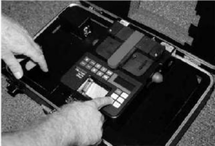
Şekil 3.29: Füzyon birleştirici (elektriksel iyonlaştırma tekniği ile) cam veya plastik uçları birleştirir
