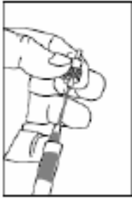
Şekil 3.16: Konnektöre epoxy enjekte edilmesi
