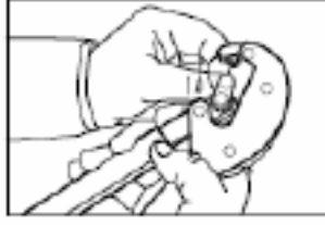
Şekil 3.18: Manşon anahtar ile sıkılarak sağlamlaştırılması
