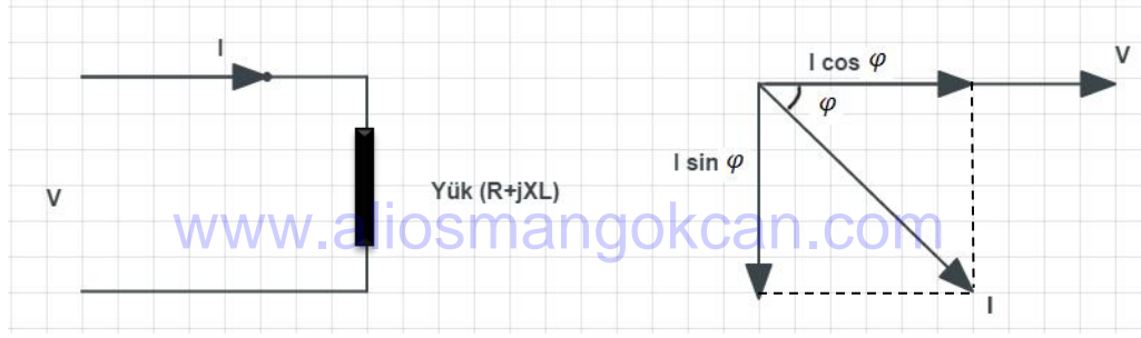
Şekil 2.1 Endüktif karakterli yük ve fazör gösterimi
