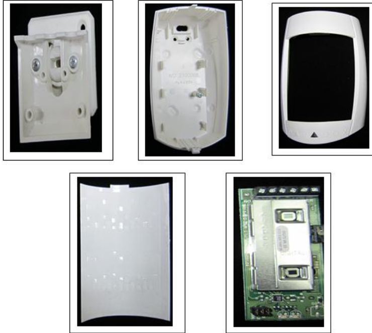
Resim 2.17: Hareket dedektörü bağlantı ayağı ve iç yapısı
