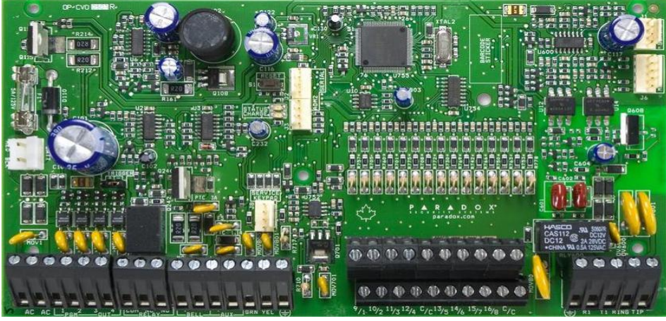
Resim 1.7.: On altı zone kontrol paneli
