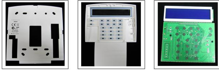
Resim 2.12: Keypadlerin demonte ve monteli görüntüleri
