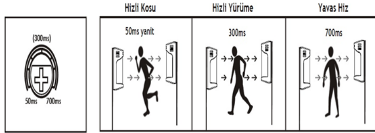
Şekil 2.39: Aktif ışın bariyerleri ( beam dedektör ) kapı montaj şekli
