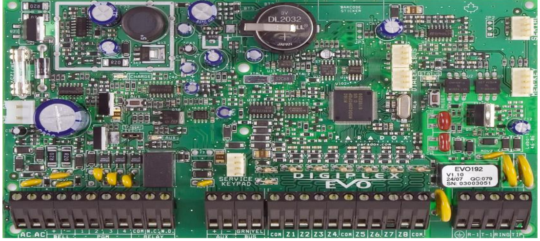
Resim 1.9: Yüz doksan iki zone kontrol paneli
