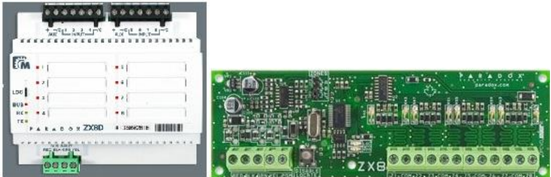
Resim 1.17: Ray montajlı ve alarm panel kutusuna montajlı genişleme modülleri
