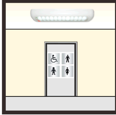
Resim 5.14: Engelli tuvaleti yanına monte edilmiş aydınlatma armatürü
