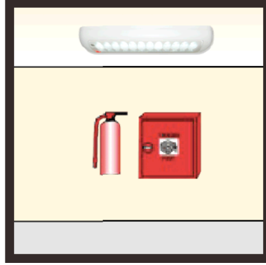
Resim 5.10: Yangın malzemelerinin üstüne monte edilmiş aydınlatma armatürü
