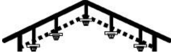
Şekil 2.28: Dedektörün eğimli ve yüksek yerlerde yerleşimi
