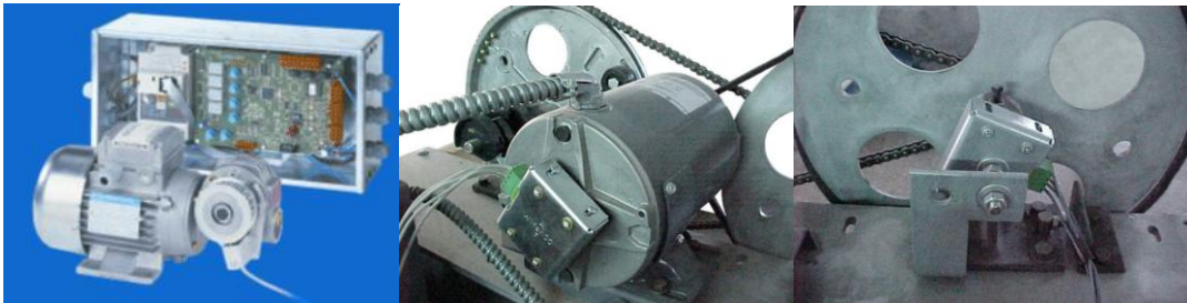
Resim 1.12: Kapı kanadı kontrol üniteleri ve adım kontrol sensörü
