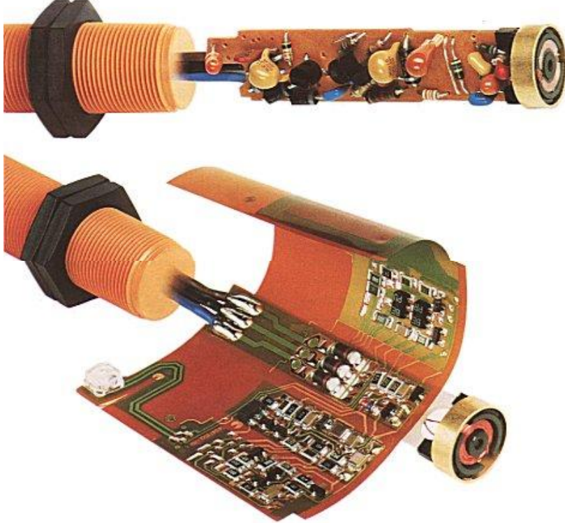
Resim 1.6: Isı algılayıcı sensörler
