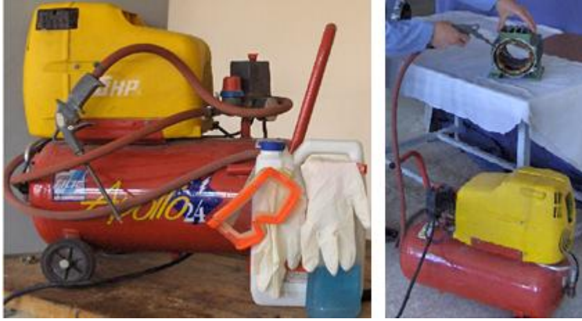
Resim 1.8: Basınçlı hava üreten hava kompresörü ve kompresörle toz alma
