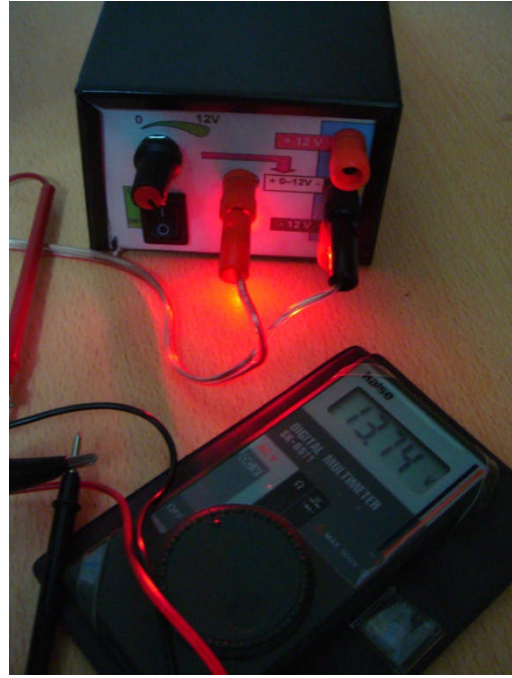
Resim 5.2: Güç kaynağının potansiyometresimaksimum (13.74 V) ve minimum (1.256 V) değerinde
