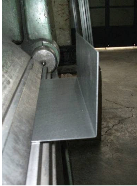
Resim 1.8: Güç kaynağı kutusunun caka yardımı ile bükülmesi
