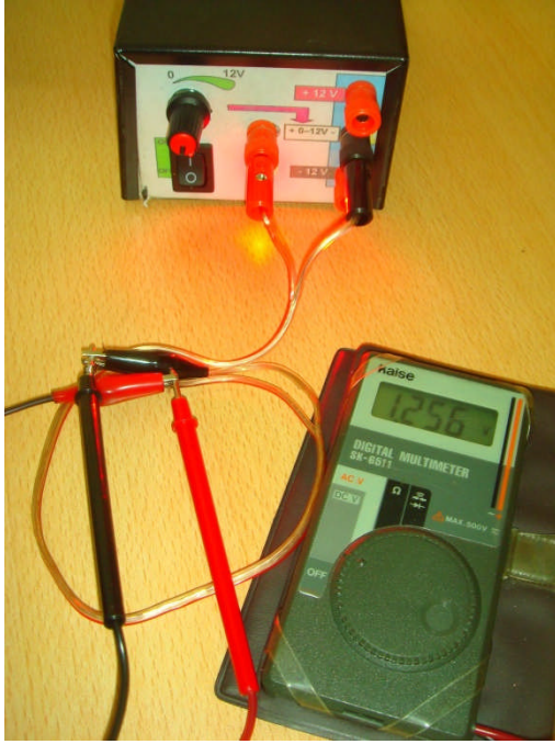
Resim 5.2: Güç kaynağının potansiyometresimaksimum (13.74 V) ve minimum (1.256 V) değerinde
