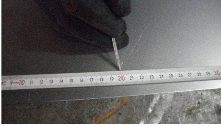
Resim 1.3: Güç kaynağı sacının ölçülmesi
