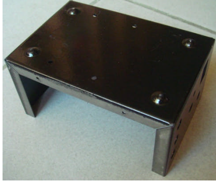
Resim 1.11: Güç kaynağı kutusunun gövdesi (alttan görünüş)
