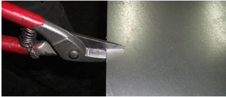
Resim 1.5: Güç kaynağı sacının sac makası ile kesilmesi
