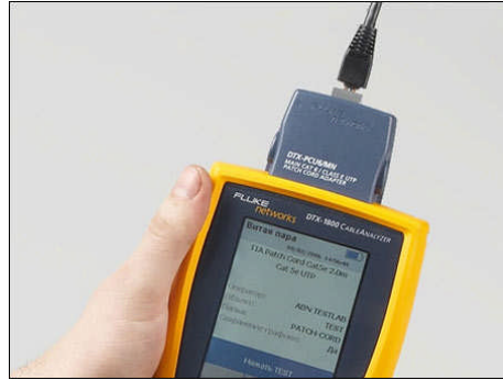
Resim 2.29: Kablounun test edilmesi
