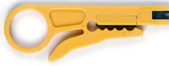
Resim 2.5: Kablo temizleme, bükümlü çiftleri ayırma aleti
