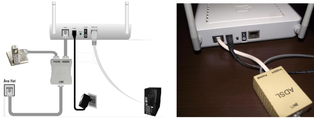
Resim 1.9: Kablosuz modem kablo bağlantısı
