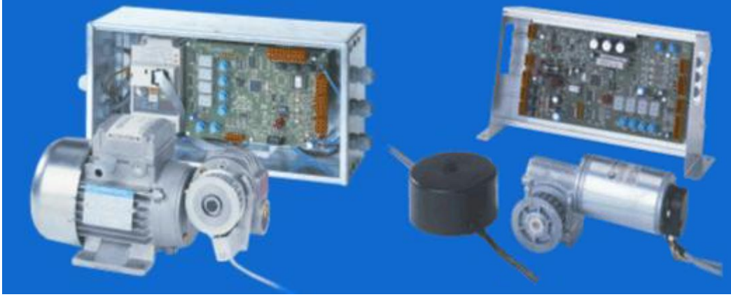
Resim 2.5: Kapı motoru sürücü devreleri
