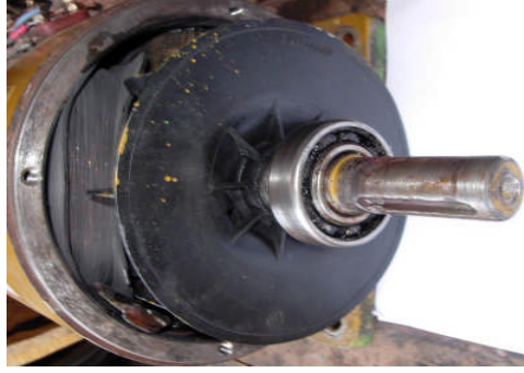
Resim 1.18 a-b-c: Rulmanın boru ile yerleştirilmesi
