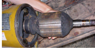
Resim 1.5: Endüviyi gövdeye yerleştirme
