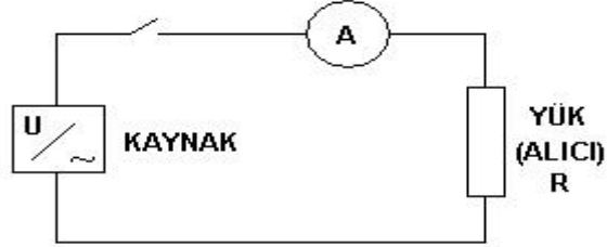
Şekil 2.1: Ampermetrenin devreye bağlanması
