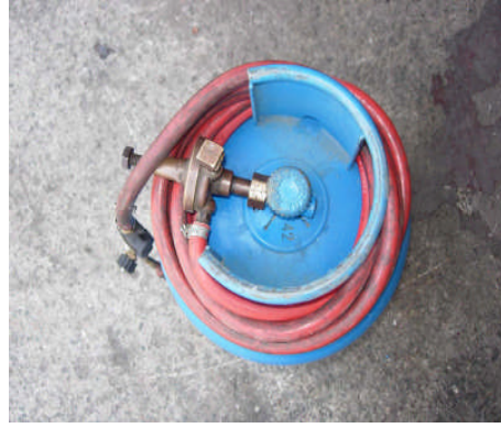
Resim 1.13 a-b: Mutfak tüpüne pürmüz başlığı takılması
