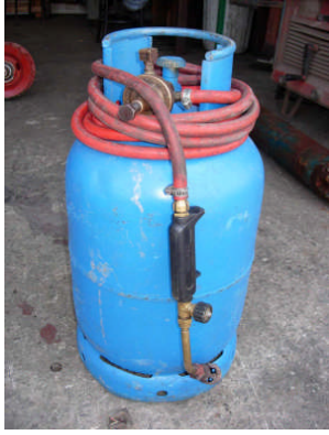
Resim 1.13 a-b: Mutfak tüpüne pürmüz başlığı takılması
