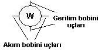
Şekil 2.7: Wattmetre akım ve gerilim bobin uçları
