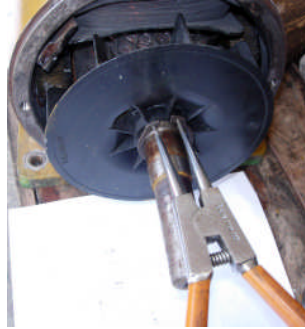
Resim 1.15 a-b-c: Soğutucu pervaneye segman takılması
