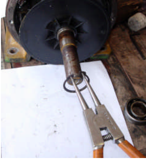
Resim 1.15 a-b-c: Soğutucu pervaneye segman takılması
