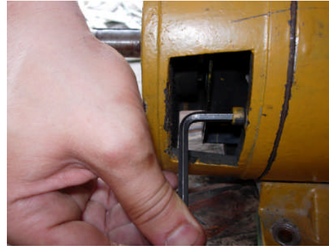
Resim 1.29 a-b:Saplama vidalarının sıkılması
