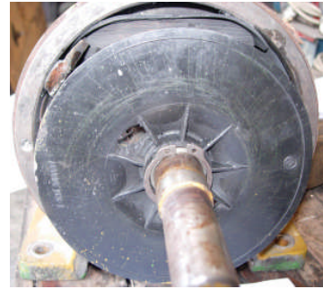
Resim 1.15 a-b-c: Soğutucu pervaneye segman takılması
