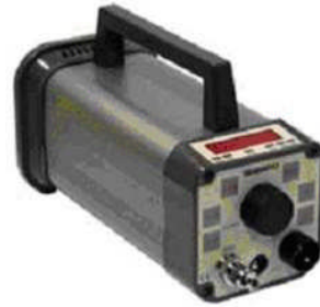
Resim 2.6 a-b-c-d: Stroboskopik (ışık yayarak çalışan) turmetreler
